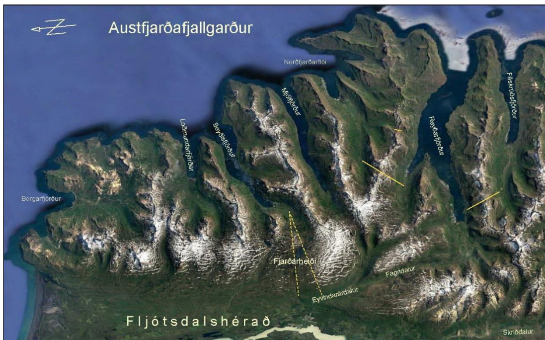
Mynd 1.1. Fjallgarðar Austfjarða norðan Fáskrúðsfjarðar. Fyrirliggjandi jarðgöng eru sýnd með gulum línunum og hugmyndir að legu Fjarðarheiðarganga með brotalínunum.
