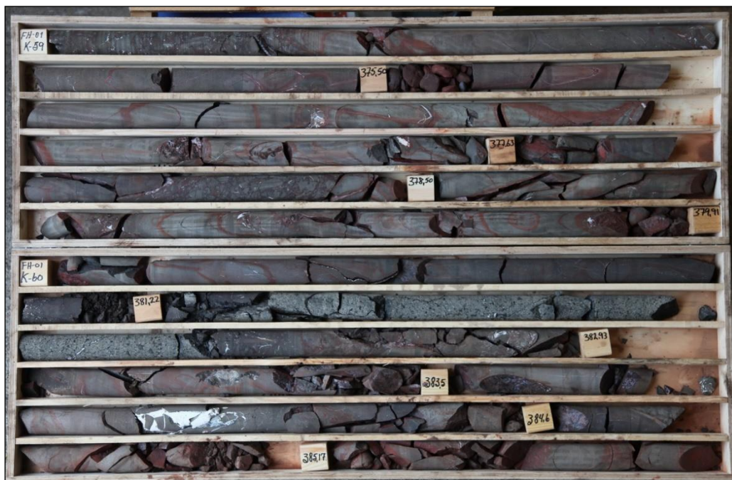
Mynd 4.3. Bergið á 375-385 m dýpi í borholunni reyndist mjög brotið og lekt og borun fór að ganga erfiðlega.
